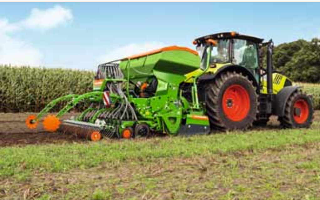
Centaya 3000 Super з однодискowymi сошниками RoTeC pro
