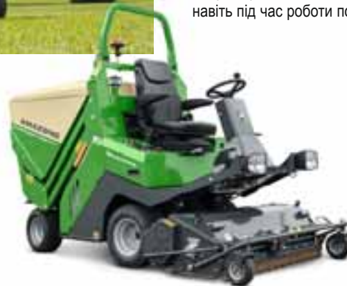
Profihopper 1250 iDrive SmartLine з переднім приводом і нульовим радіусом повороту
