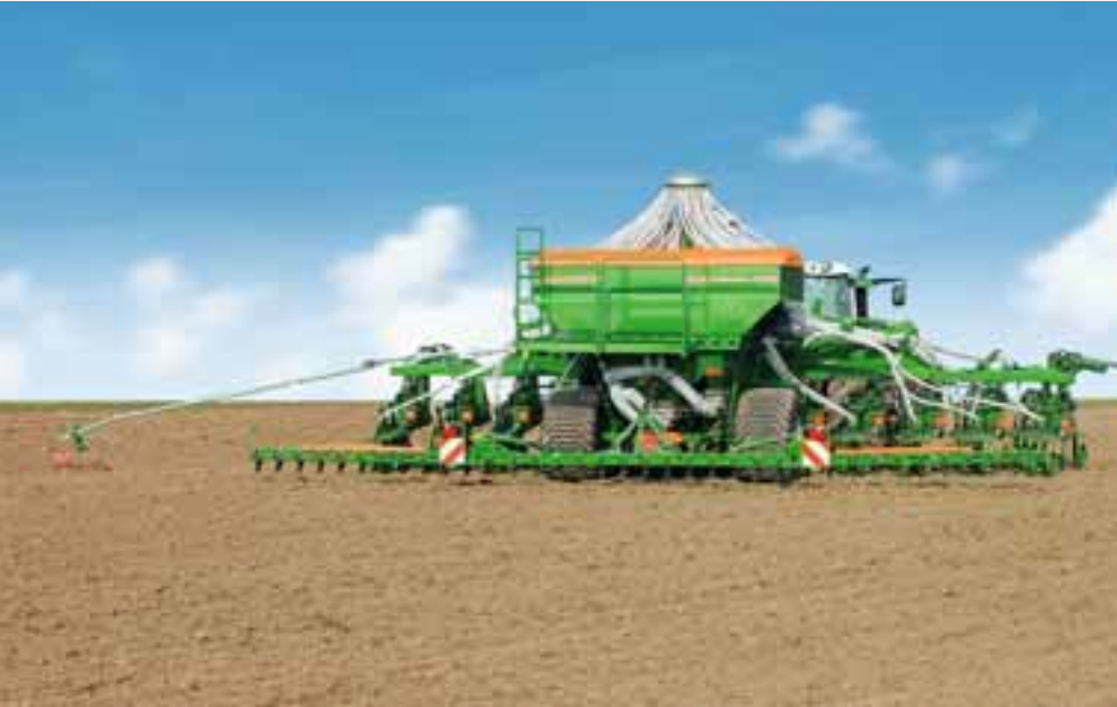
Primera DMC 9000, ширина захвату 9 м
