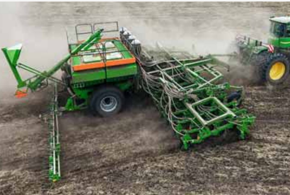
Primera DMC 12001-2C, ширина захвату 12 м із зовнішніми розподільними голівками
