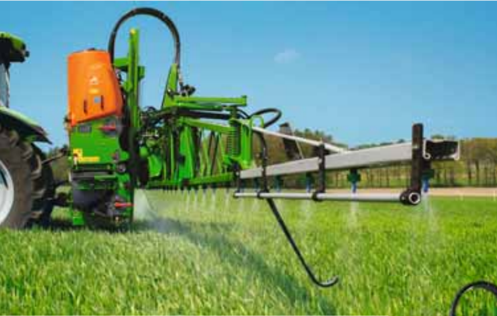
Навісний обприскувач UF 1201 зі штангою Super-S2 18 м
