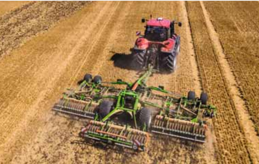
Catros+ 8003-2TX із гумово-клиновим котком з шинами Matrix, що має ширину захвату 8 м
