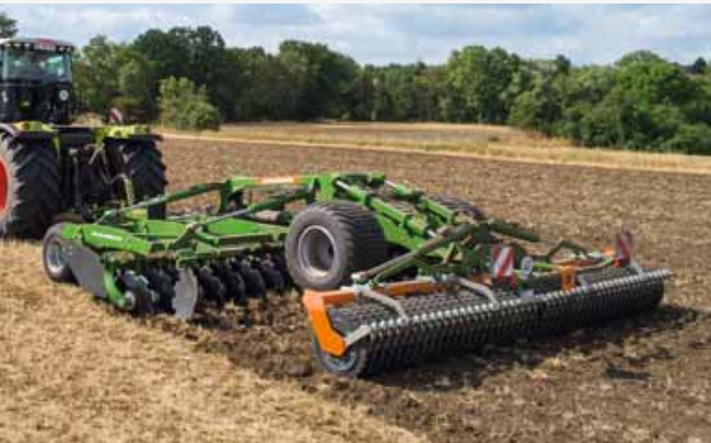
Certos 6002-2TX з шириною захвату 6 м з центральним шасі TX в роботі
