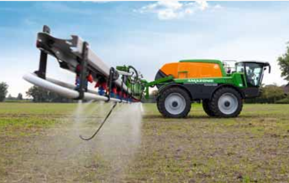
Самохідні обприскувачі Pantera 4503 з кліренсом 1,2 м
