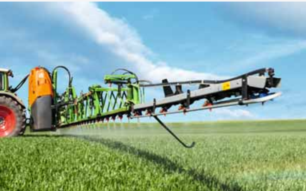
Навісний обприскувач UF 2002 зі штангою Super-S2 30 м
