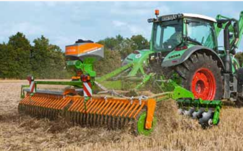
Catros + 5002-2 із шириною захвату 5 м та вирізними дисками (діаметр 510 мм)
