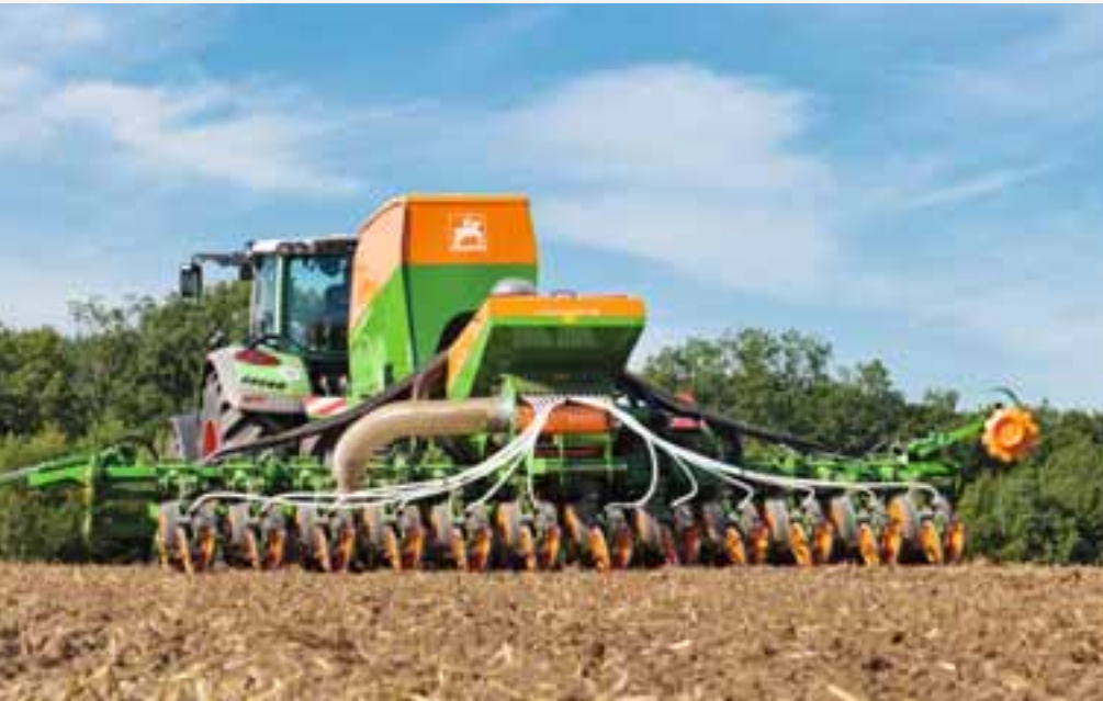
Сівалка точного висіву EDX, ширина захвату 6 м
