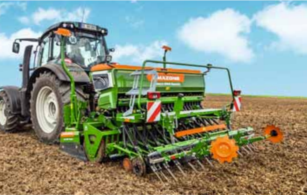
Cataya 3000 Special із сошниками RoTeC та штригелем Exakt
