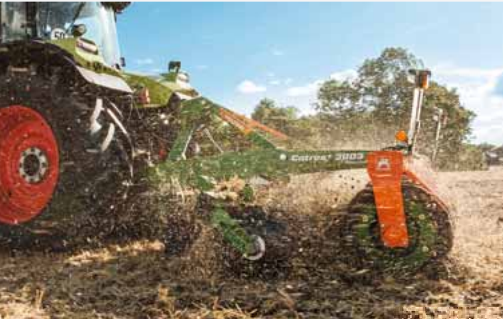
Catros+ 3003 Special з вирізними дисками, яка має ширину захвату 3 м
