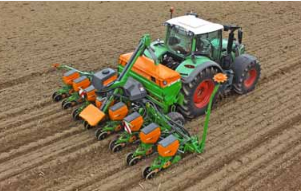
Сівалка точного висіву ED 6000-2C Super
