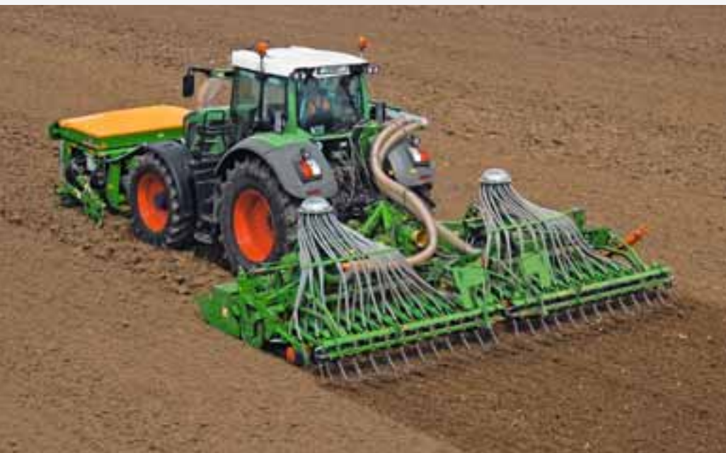
Avant 6000-2, ширина захвату 6 м
