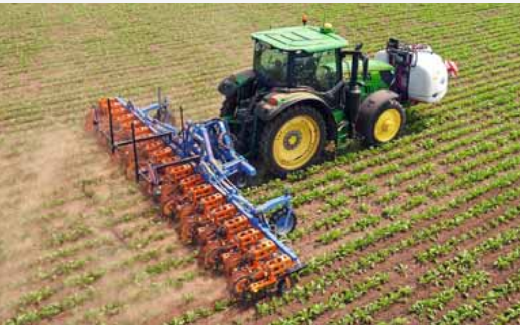
Просапання в комбінації зі стрічковим обприскуванням
