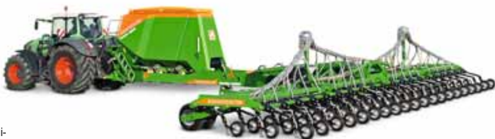
Condor 15001: великий на полі — компактний під час транспортування завдяки транспортній ширині 3 м
