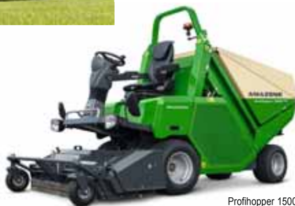
Profihopper 1500 4WDi SmartLine з інтелектуальним повним приводом і нульовим радіусом повороту
