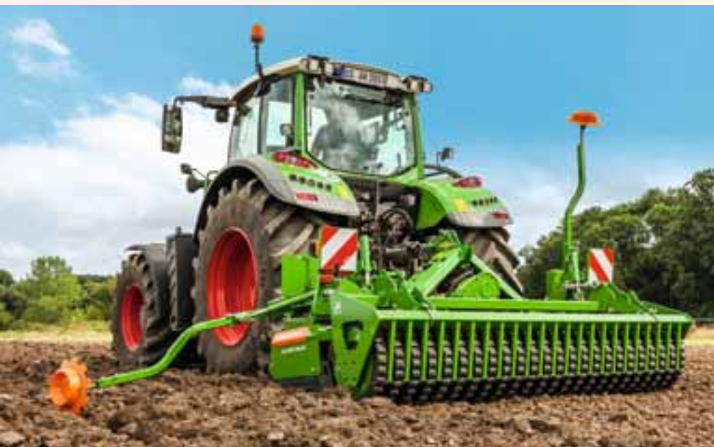
Ротаційний культиватор KG 3001 з резино-клиновим котком із шинами Matrix
