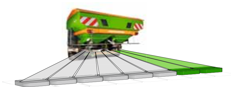
3 8- або 16-кратним індивідуальним ввімкненням секцій для ZA-V можна керувати окремими секціями, розташованими ззовні
