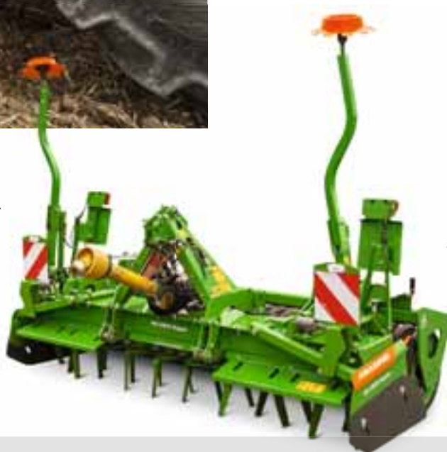
Ротаційна борона KE 3001 Super із насадною сівалкою Cataya 3000 Special
