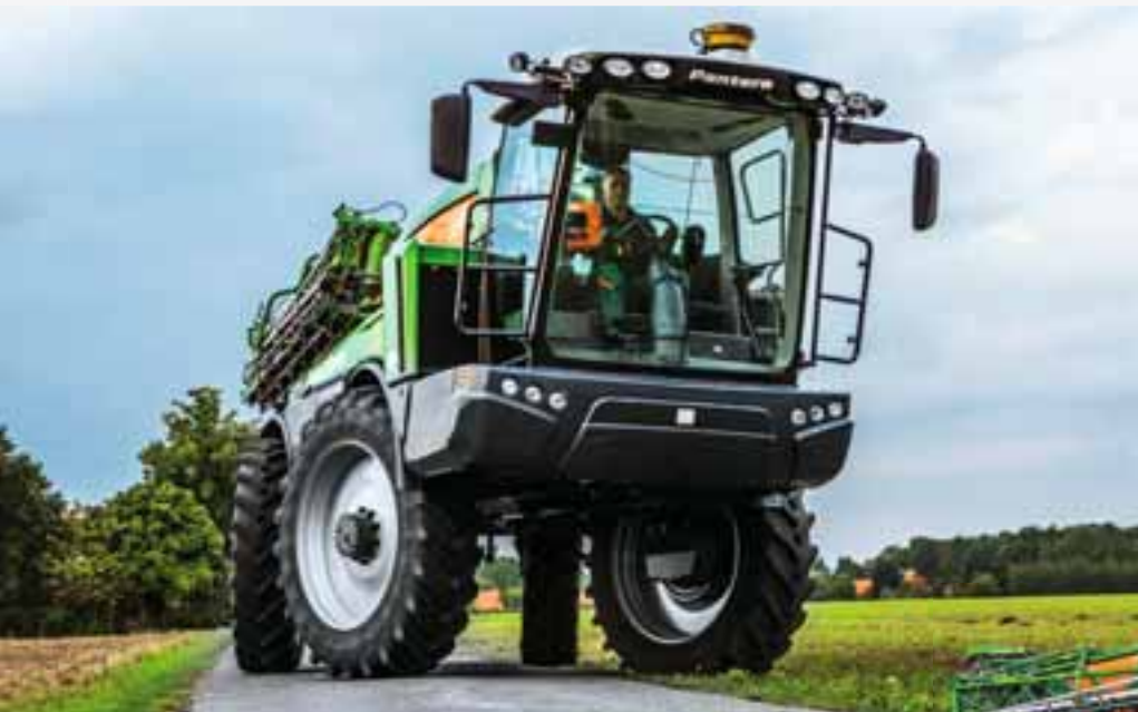
Самохідний обприскувач Pantera 4503 з компактною конструкцією й керуванням всіма колесами
