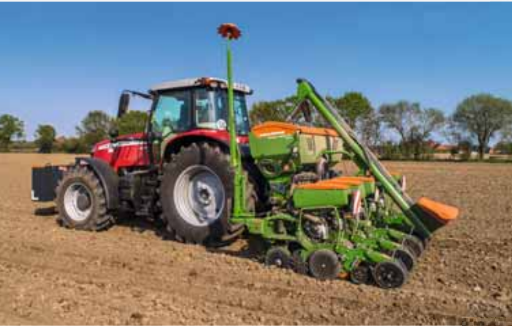
Сівалка точного висівання Precea 4500-2CC, 6-рядна
