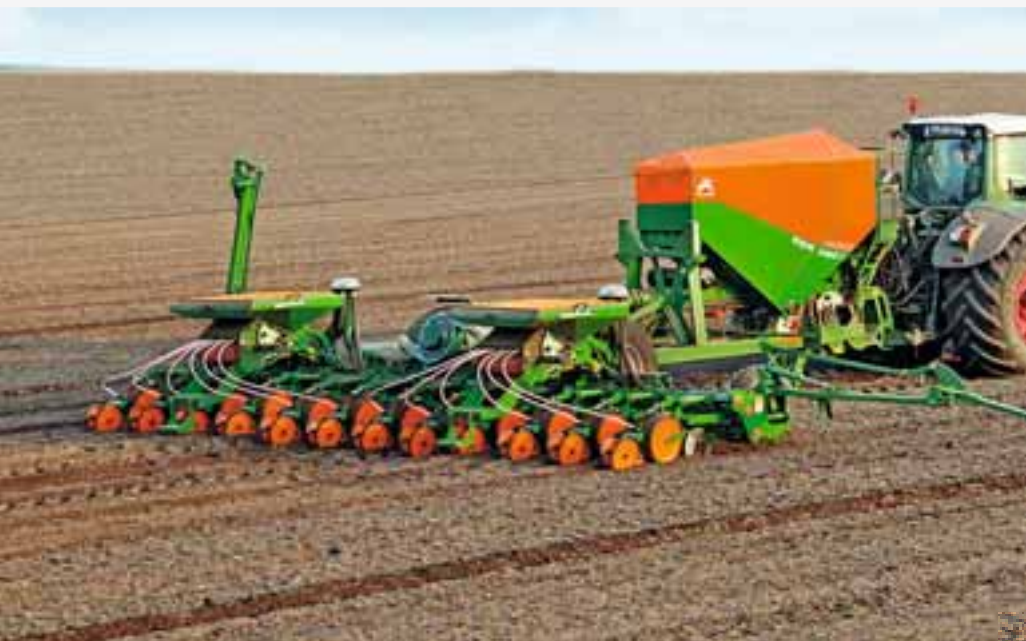
Причіпна сівалка точного висіву EDX 9000-TC, ширина захвату 9 м
