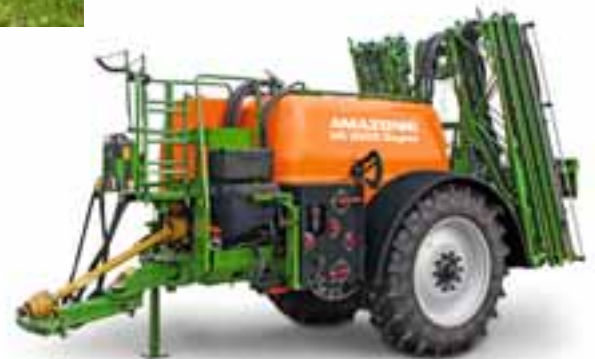
Причіпний обприскувач UG 3000 Super зі штангою Super-S2 від 15 до 28 м
