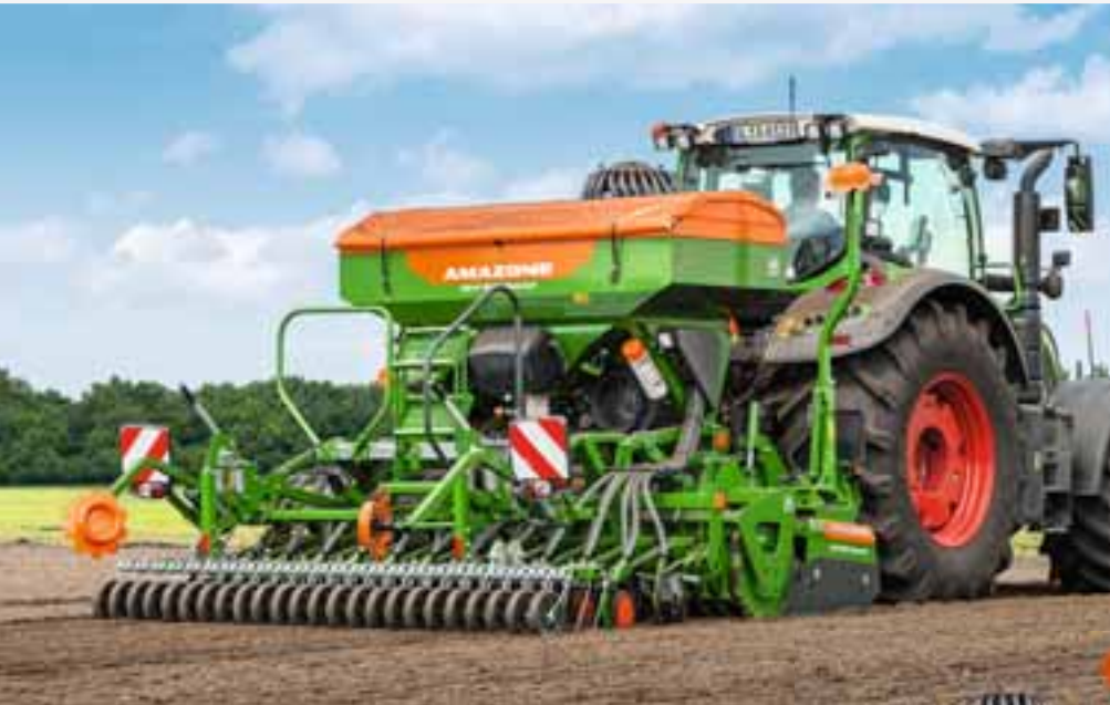
AD-P 3001 Special із сошниками RoTeC і балкою для прикочування
