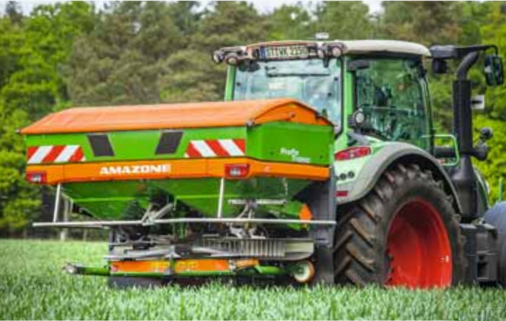
Розподільник з пристроєм для зважування ZA-V 2000 Profis Tronic, оснащений пристроєм Limiter V +
