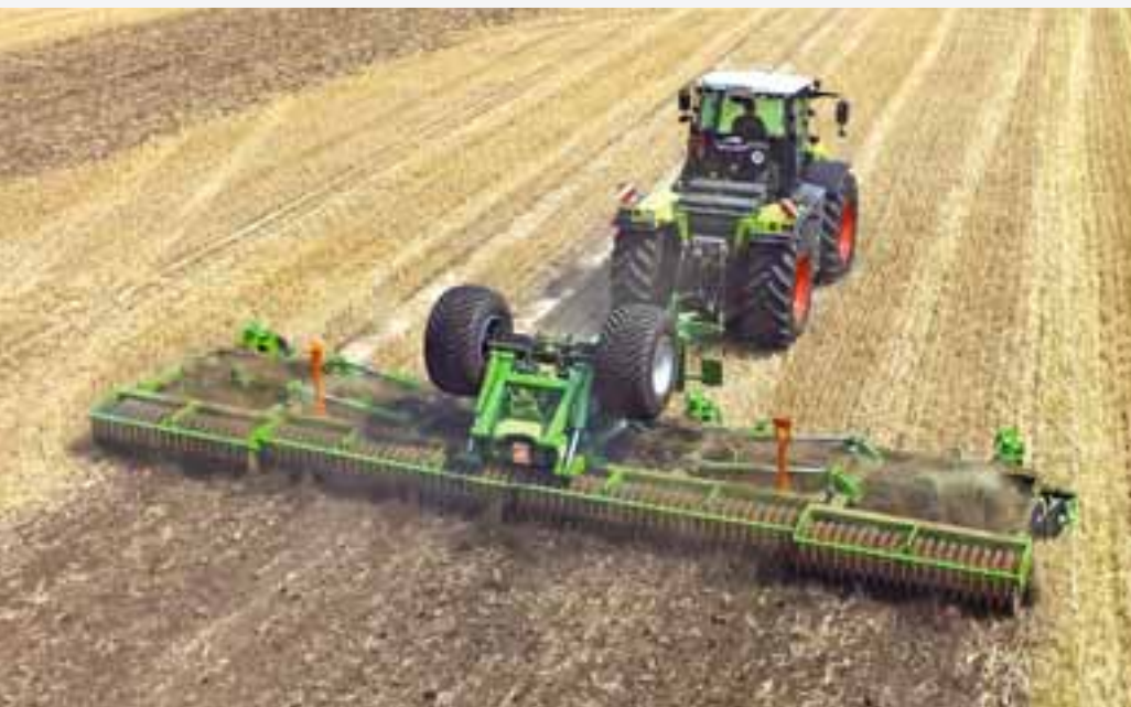
Catros + 12003-2TS із шириною захвату 12 м під час обробітку стерні
