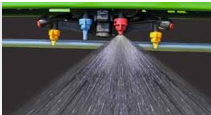
Електричне індивідуальне ввімкнення форсунок AmaSelect з 4-корпусним тримачем форсунок і відстанню між форсунками 50 або 25 см
